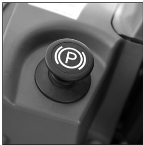
Ideal – betätigen der automatischen Handbremse per Knopf
